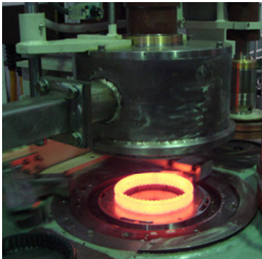
Peć za indukcijско poboljšavanje čelika
