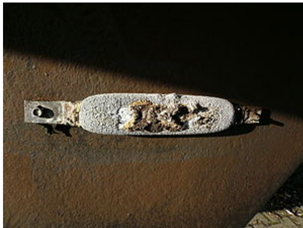
Primjer žrtvovane anode na trupu broda.
