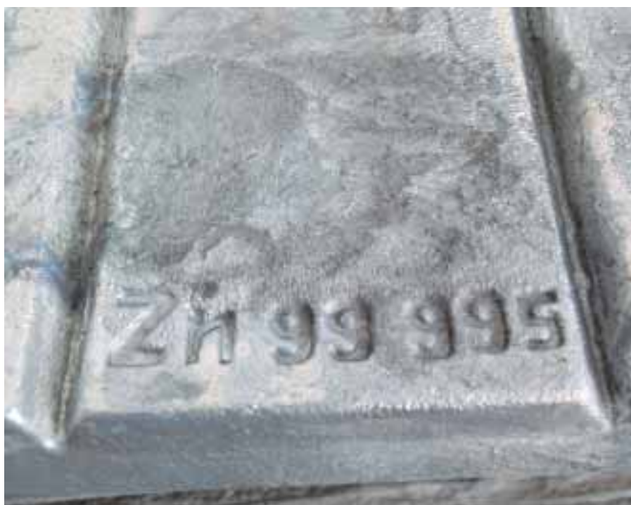
Sirovina, tj. cink ploče, imaju utisnutu oznaku čistoće. U ovom slučaju to je 99,995 %.
