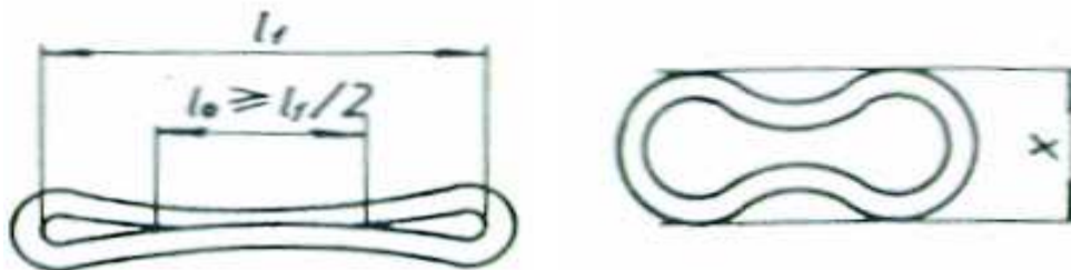
Slika 7.8: Ispitivanje cijevi spljoštavanjem
