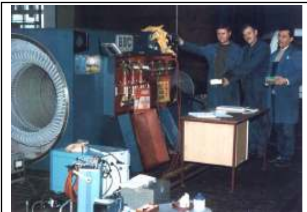
Stator visokonaponskog asinkronog motora (400 kW) u TE Rijeka
