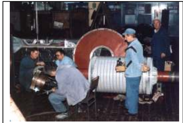
Rotor visokonaponskog asinkronog motora (400 kW) u TE Rijeka
