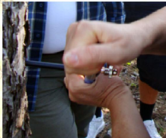
E. Okreni svrdlo obrnuto od kazaljke na satu kako bi odsjekao izvrtak
