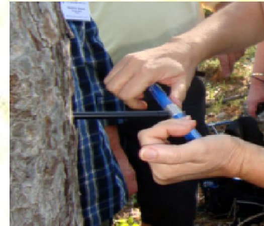
C. Okreći u smjeru kazaljke na satu dok ne izbušiš rupu do srži drva
