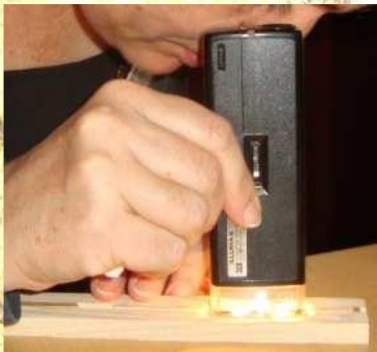
A. Povećalom prouči izvrtak i odredi zadnji god
