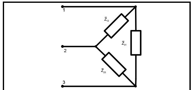
6. Koliku ukupnu prividnu snagu uzima mreža sa slike iz izvora napajanja. Poznati su sljedeći podaci:  $\bar{X}_{L_1} = j10\Omega$ ,  $\bar{X}_{L_2} = j8\Omega$ ,  $\bar{X}_{C_1} = -j10\Omega$ ,  $R_2 = 8\Omega$ ,  $\bar{X}_M = j8\Omega$  i  $U = 120\text{V}$ .
