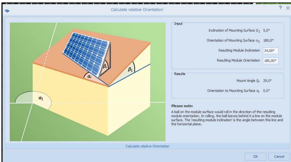
Klikom na OK potvrđuju se upisane vrijednosti. Tada se izabere broj horizontalnih modula u redu u izborniku *Number of horizontal Modules*. Pritisom na tipku *Cover the Mounting Surface*, automatski se postave FN moduli i po potrebi pozicioniraju.
