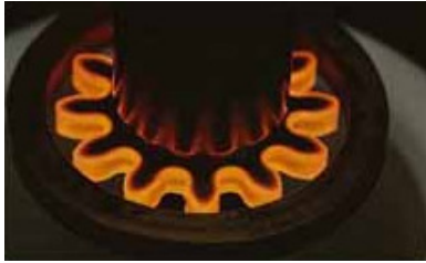
Površinsko zagrijavanje plamenom zupčanika za kaljenje
