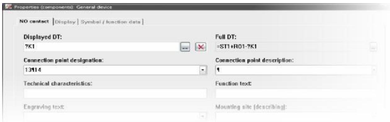
Klikne se na [...] kod opcije **Displayed DT** te se pojavi kartica na kojoj se na jednostavan način odabere ime iz izbornika pomoću navigadora koji prikazuje već prethodno definirani element.
